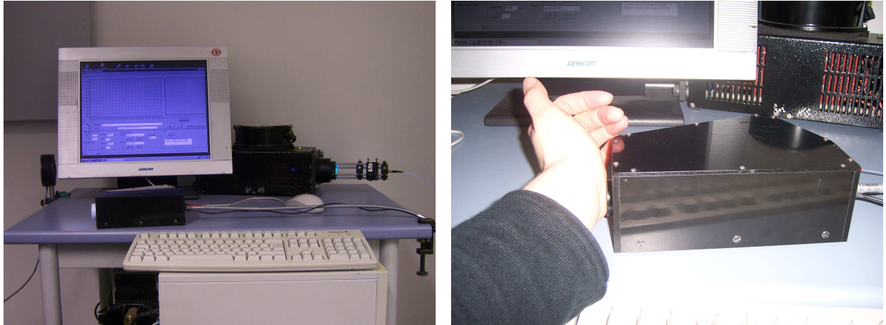
Abb. 3: Raman-Resonanz-Spektroskop (links) und Messung am Handballen (rechts)
