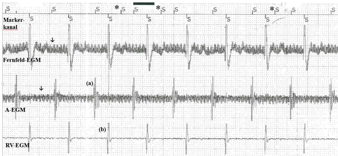
Abb. 18: EGM mit EMI während TENS (HWS, 80 Hz, 87 mA). Atriales Oversensing (AS).
