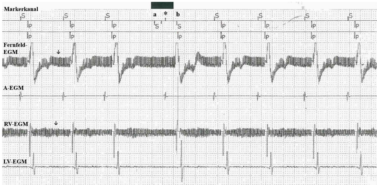
Abb. 27: EGM mit EMI während TENS (Thorax, 80 Hz, 100 mA). Fehldetektion als rechtsventrikuläres Sense-Ereignis (S).
