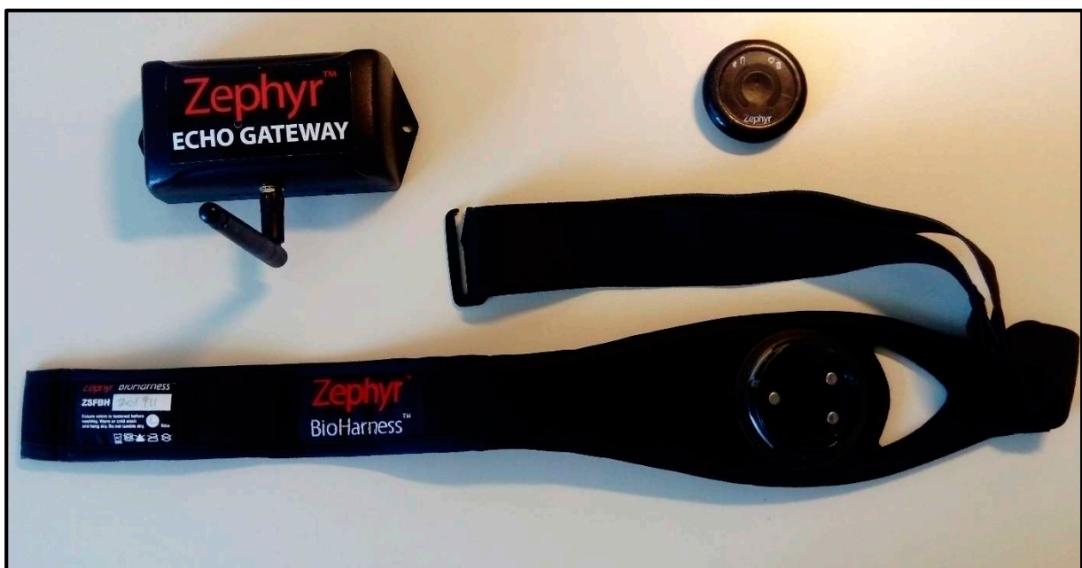
Abbildung 2: Außenseite des BioHarness™ 3-Systems
