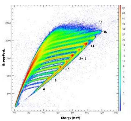
**Abbildung 28:** Braggpeak-Range- und Braggpeak-Energie-Korrelationen einer der beiden Bragg-Kammern ( $^{36}$ Ar +  $^{24}$ Mg). Die Skalierung der x-Achse ist in der oberen Abbildung von rechts nach links zu lesen und in der unteren Abbildung von links nach rechts. Zu sehen ist die gute Ladungs-Trennung der nachgewiesenen Ionen in den getrennten Ästen.
