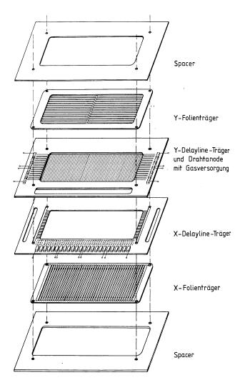
Abbildung 20: Aufbauzeichnung der Niederdruckvieldrahtkammer (aus [Wil85]).
