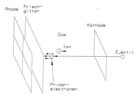
Abbildung 21: Schematische Darstellung der Bragg-Ionisationskammer (aus [Kir94]).
