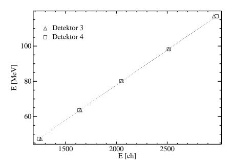
Abbildung 29: Energie-Eichung der beiden Bragg-Kammern. Aufgetragen ist die Energie des Teilchens aus der Energieverlust-Simulationsrechnung gegen die Kanalzahl an der Abbruchkante für verschiedene Z-Werte, d.h. der Stelle im Braggpeak-Energie-Korrelationsplot, bei der das Teilchen gerade nicht mehr in der Bragg-Kammer gestoppt wird. Der Fehler in der Energiebestimmung beträgt ca. 2 MeV. Dies entspricht etwa der Größe der Symbole.
