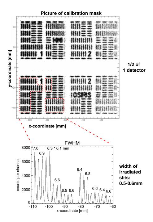
**Abbildung 25:** Ortseichung der MWC mit Hilfe einer Schlitzblende. Zu sehen ist oben der Scatter-Plot der Ortskoordinaten und unten die Projektion des umrandeten Teils der senkrechten Schlitze auf die x-Achse ( $^{36}$ Ar +  $^{197}$ Au).
