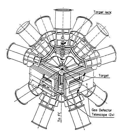
**Abbildung 18:** Aufbau des OSIRIS  $\gamma$ -Spektrometers mit den beiden BRS-Trigger-Detektoren.
