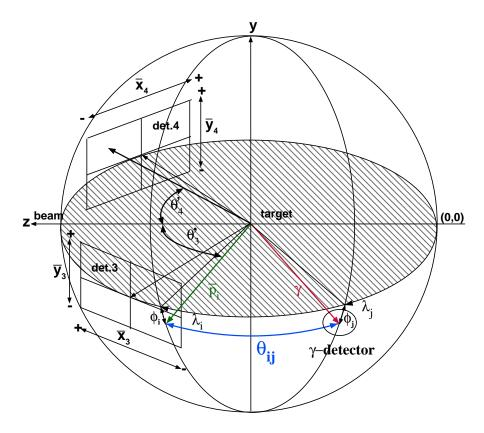
Abbildung 32: Definition der zur Doppler-Korrektur verwendeten Winkel (vgl. auch Abbildung 24, S. 39).
