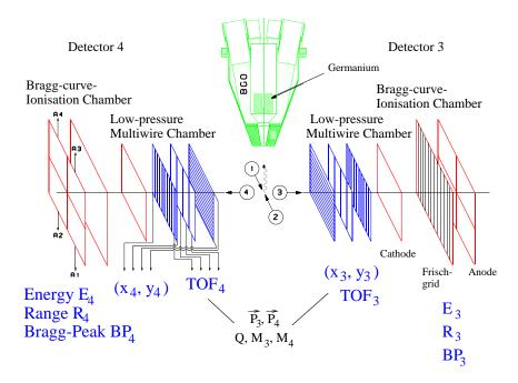
Abbildung 19: Schematische Aufbauzeichnung der BRS-Teleskope und der damit erhaltenen Meßgrößen. Erläuterung siehe Text.
