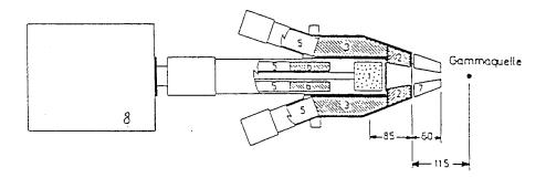
**Abbildung 23:** Querschnitt durch einen Ge-Detektor. 1 - Ge-Detektor, 2 - NaJ-Szintillator, 3 - BGO-Szintillator, 5 - Photomultiplier, 6 - Zusatzszintillator, 7- Schwermetall-Kollimator, 8 - Kryostat mit LN<sub>2</sub>.
