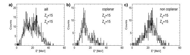
Abbildung 41: Q-Wert-Verteilung für den Kanal  $Z_3 = Z_4 = 15$ . Der  $Q_0$ -Wert beträgt für diesen Kanal -3.8 MeV. In Teil b) ist nur der scharfe Peak in der *out-of-plane*-Winkelverteilung (siehe Abbildung 37, S. 53, 1. Spalte unten) gefordert und in Teil c) der äußeren Bereich der Verteilung.
