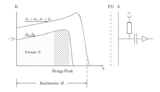
Abbildung 22: Funktionsweise der Bragg-Ionisationskammer.—K, FG, A: Kathode (aus [Sch95]).
