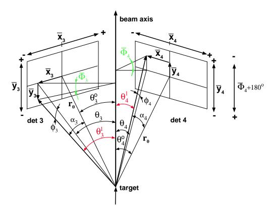
**Abbildung 24:** Aus der Ortsmessung abgeleitete Streuwinkel. Die im folgenden verwendeten Winkel  $\bar{\Phi}_{3,4}$  und  $\theta_{3,4}^l$  sind farbig gekennzeichnet.  $\theta_{3,4}^l$  sind dabei die reinen Streuwinkel im Laborsystem und  $\bar{\Phi}_{3,4}$  die out-of-plane-Winkel, mit der sich die Abweichung der detektierten Teilchen aus der Streuebene beschreiben läßt.
