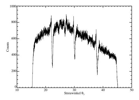
**Abbildung 27:** Verteilung des Streuwinkels  $\theta^l$  (im Plot als  $\theta_3$  bezeichnet) für einen der beiden BRS-Detektoren ( $^{36}$ Ar +  $^{24}$ Mg). Die gezeigte Verteilung zeigt die Daten ohne Normierung auf den tatsächlich abgedeckten Streuwinkel.
