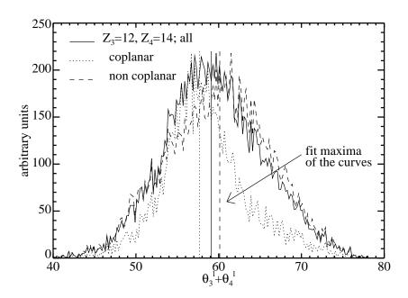
**Abbildung 40:** Summe der Streuwinkel  $\theta_3^l$  und  $\theta_4^l$  für festes  $Z_3 = 12$  und  $Z_4 = 14$ . Gezeigt sind die Winkelverteilungen für den koplanaren und nicht-koplanaren Anteil in der *out-of-plane*-Winkelkorrelation, sowie, gekennzeichnet durch die vertikalen Linien, das jeweilige Maximum des Fits der Winkelverteilung.
