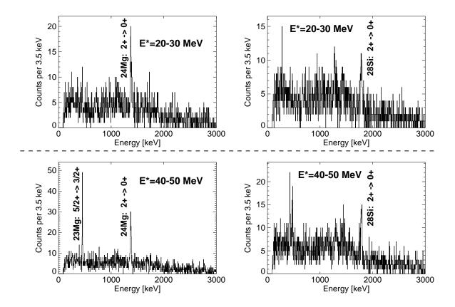
Abbildung 45:  $\gamma$ -Spektren für  $Z_3 = 12$  und  $Z_4 = 14$  in zwei Q-Wert-Bereichen von jeweils 10 MeV Breite. Die Spektren sind Doppler-korrigiert einmal auf den detektierten  $Z_3=12$ -Kern (linke Spalte) und einmal auf den detektierten  $Z_4=14$ -Kern (rechte Spalte).
