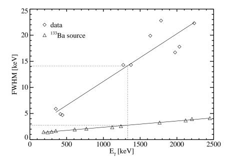
**Abbildung 30:** Energie-Auflösung der Ge-Detektoren. Gezeigt sind die gefitteten Halbwertsbreiten der Linien für die Doppler-korrigierten Meßdaten ( $\diamond$ ) und für eine <sup>133</sup>Ba-Quelle ( $\triangle$ ). Die gepunkteten Hilfslinien dienen zur Kennzeichnung der Auflösung bei 1.3 MeV.
