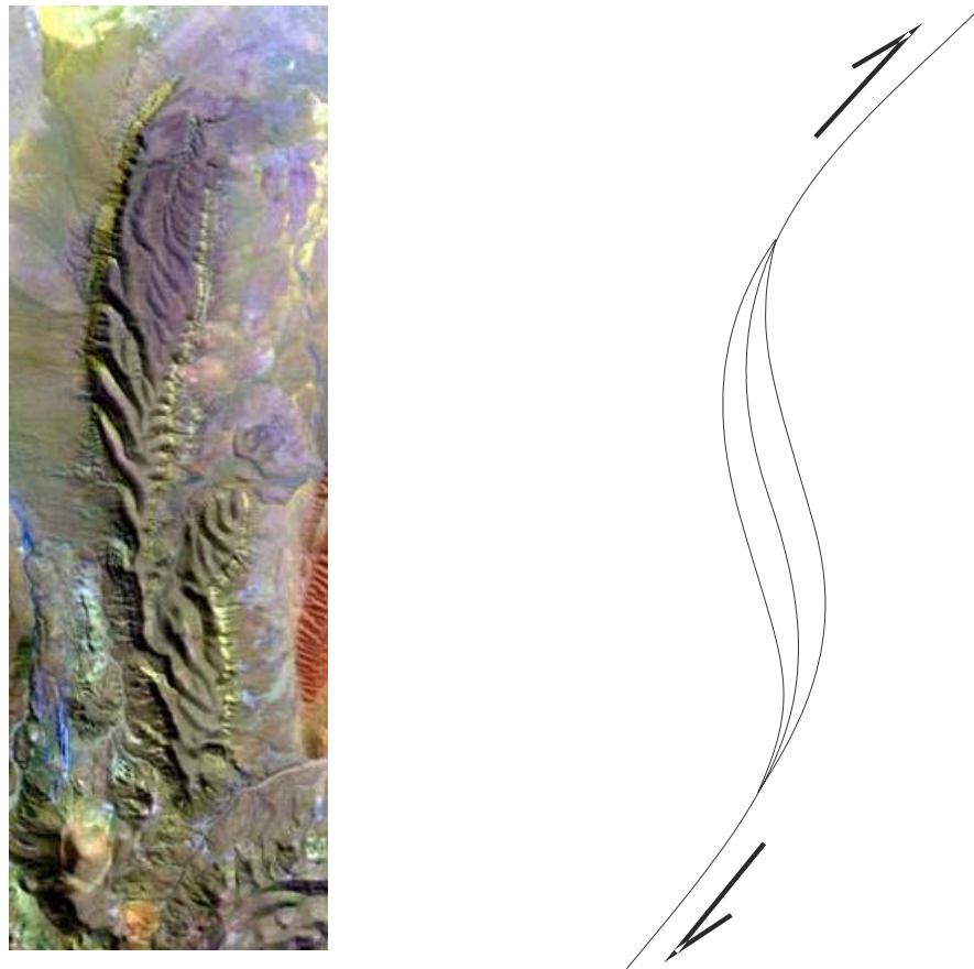
Abb. 4-19: Beispiel einer sigmoidalen Druckrückenstruktur (links) im Satellitenbild mit der dazugehörigen schematischen Darstellung des Verhaltens einer sigmoidal verbogenen Blattverschiebung mit dextralem Bewegungssinn. Lage des Ausschnittes siehe Verzeichnis der Abbildungstafeln.
