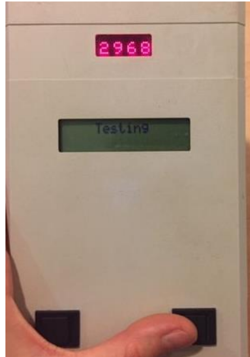
Abbildung 3: Das PVT-Gerät und seine Handhabung. Sobald eine rote Zahl in der Anzeige erscheint, muss die rechte Taste gedrückt werden. Das Ergebnis erscheint auf der Anzeige in Millisekunden.
