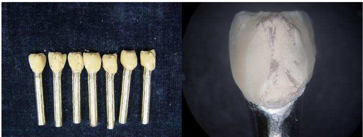
Abbildung 17: Visuelle Begutachtung der einzelnen Kronen nach erfolgtem VOSS-Test (Bsp. Bio Pontostar)
