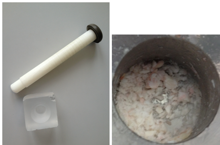
Abb. 20: Speziell angefertigter Mörser zur Homogenisation des Meniskusgewebes
