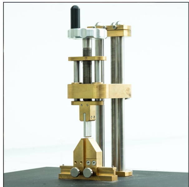
Abb. 3: Links , Kleber C, 2012, AG Polytrauma: Mausfemur mit angebrachtem Fixateur externe und mittlerer Osteotomie. Rechts : verwendete Vorrichtung zur Erzeugung der Biegefraktur im Bereich der Tibia mittels 3-Punkt-Biegetechnik.
