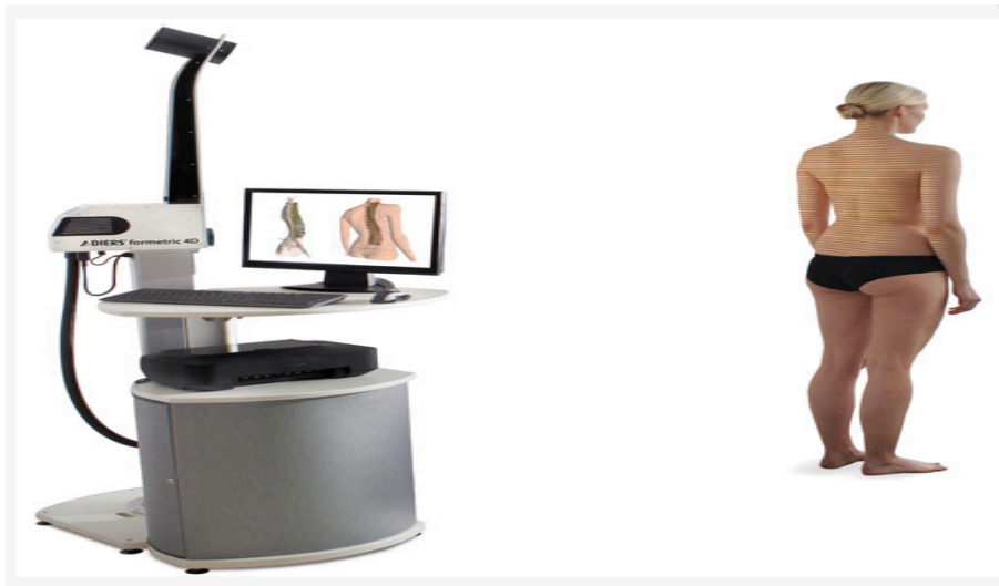
Abbildung 16: Aufnahmesystem für die Videorasterstereografie (VRS): Videokamera, Projektor, Bildschirm, Computer (Quelle: Diers, Biomedical Solutions, Firma Diers International GmbH, 2016)
