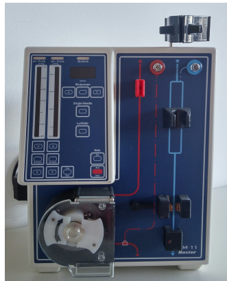
BM11–Baxxter als Filtersystem zur Plasmaseparation
