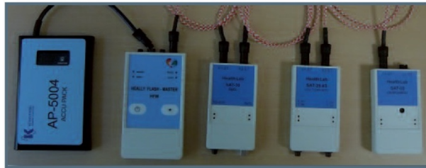
Abbildung 19: „Messsystem HealthLab mit Stromversorgung, einem Master und zwei Satelliten, an die die jeweiligen Sensoren angeschlossen werden, sowie einem dritten Satelliten zur Erfassung der Umweltparameter (Luftdruck, -temperatur und -feuchtigkeit)“ [38]
