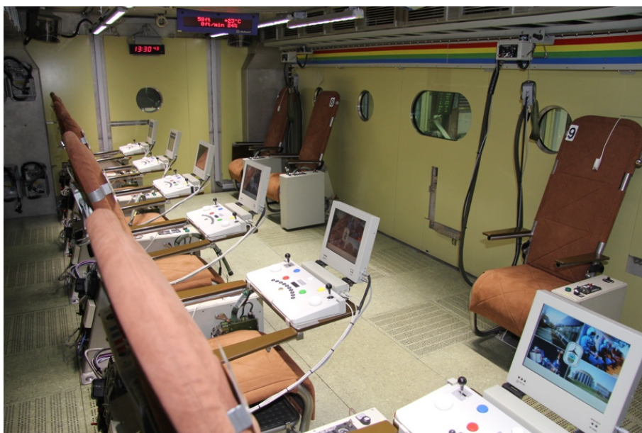
Abbildung 26: Innenraum Höhen-Klima-Simulationskammer mit Probandenplätzen [79]
