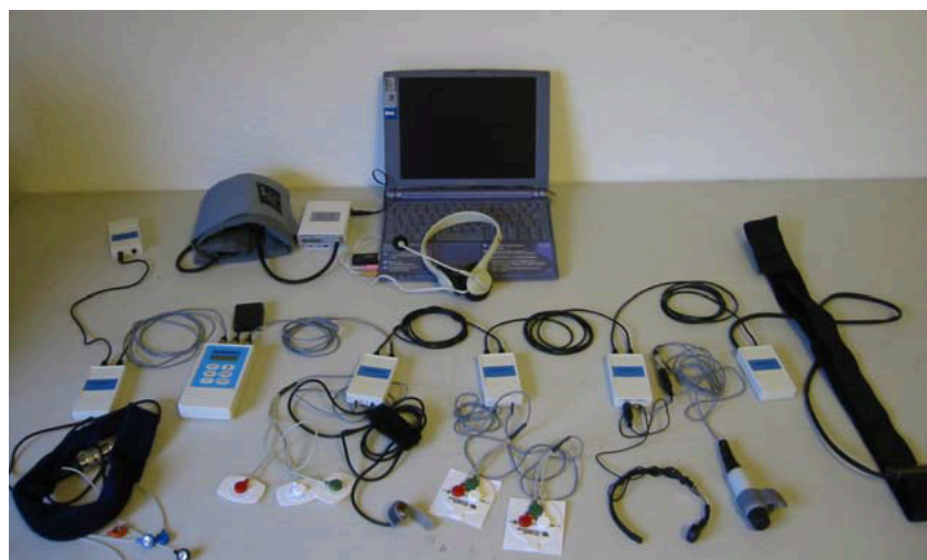
Abbildung 18: HealthLab mit Master und mehreren Satelliten, Kabeln und entsprechenden Sensoren mit Datenauswertung über Laptop [63]
