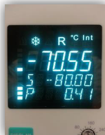
Abbildung 180: Julabo erreicht -70^{\circ}\text{C}
