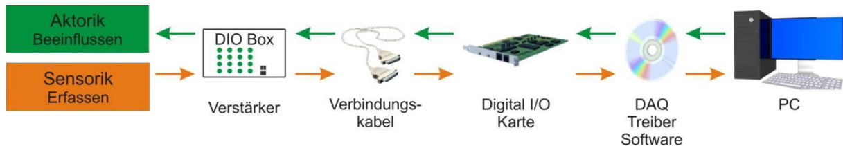
Abbildung 81: Die Ventilsteuerung erfolgt mittels Gerätetreiber über eine Digital I/O Karte. Die Karte kann in LabVIEW direkt über die Treibersoftware angesprochen werden. Das Signal am Datenausgang der Karte muss für die Ventile auf 24 V verstärkt werden und spricht damit die Aktorik an. Die PC-Karte ist ebenfalls in der Lage parallel Messdaten weiterer Sensorik aufzunehmen.
