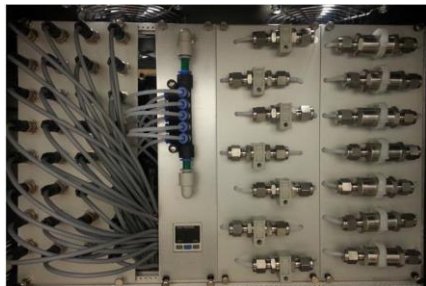
Abbildung 170: Übersicht über rückseitige Hardware-Module in kompakter, für die 19" Gerätevariante optimierter Bauweise.
