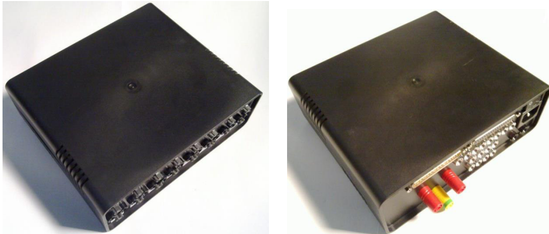
Abbildung 9: DIO – Box, links Draufsicht vorne , rechts: Draufsicht hinten – erste DIO Verstärkerbox verwendet die Spezialstecker von J-KEM aus den Alt-Synthesizern
