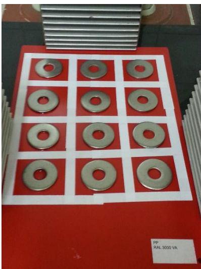
Abbildung 186: lokale Begrenzung der Lösungsmittel auf Testplatte
