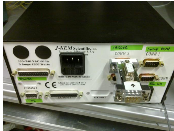
Abbildung 29: Rückseite der J-KEM Controllereinheit mit aufgestecktem Schnittstellenadapter zur Protokollierung der gerätespezifische Befehls- und Ansteuerungsprozeduren.
