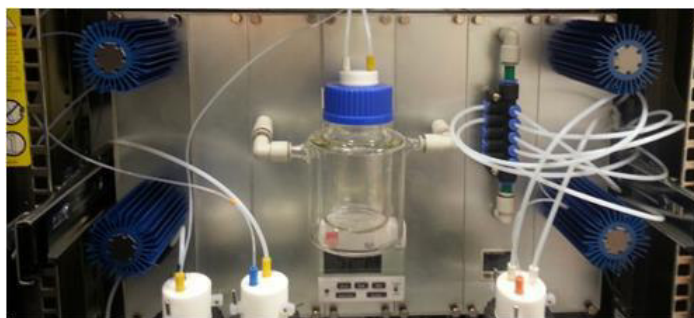
Abbildung 189: Weiterführende Systemmodularisierung – Fotoreaktor Prototyp II 19“-Bauvariante.
