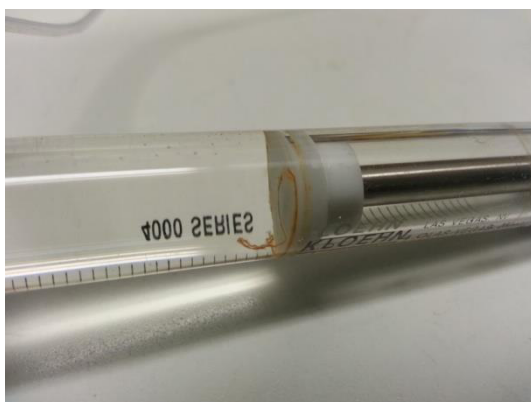
Abbildung 163: Verunreinigungen in der Transportspritze
