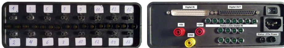
Abbildung 77: DIO Box Prototyp für die Arbeitssynthesizer I + II mit Spezialsteckeranschluss zur Ventilsteuerung. Auf der Geräterückseite finden sich die Anschlussbuchsen für das Schnittstellenkabel zum PC, Spannungsversorgung, sowie Status-LEDs zur lokalen Kontrolle der aktiven Ventilschaltung.
