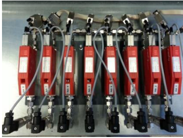
Abbildung 175: Prototyp des elektronischen Druckverteilers zur individuellen Einstellung der benötigten Versorgungsdrücke
