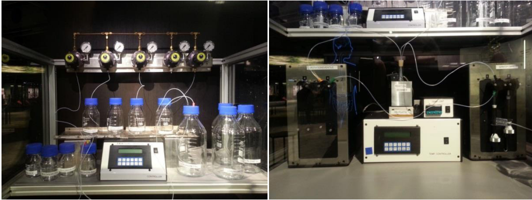
Abbildung 241: Aufbauelemente im Deutschen Technik Museum a) Druckverteiler und Lösungsmittelzufuhr (links), b) Pumpen und Rotationsventile mit Reaktor und Temperierungseinheit(rechts)
