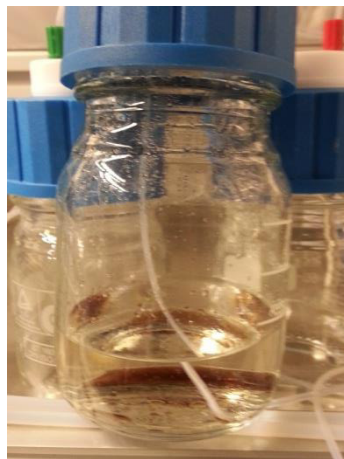
Abbildung 162: Kontamination der Deprojektorenlösung
