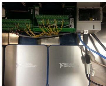
Abbildung 171: Zur Reduzierung der Gesamtgeräteabmaße ist eine platzeffiziente Anordnung der Gerätekomponenten, hier der Datenerfassungskomponenten, notwendig.
