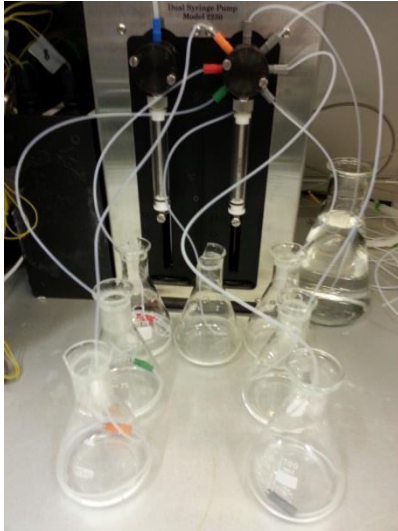
Abbildung 104: Test der Spritzenpumpen mit der Gerätetreibersoftware und Testprogrammen zur Befüllung und Entleerung
