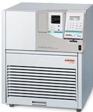
Abbildung 116: Julabo_LH85plus ist die Temperierungskomponente für die drei aufgebauten Arbeitssynthesizer
