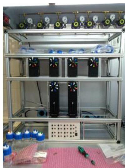
Abbildung 68: Einbaupositionen der wichtigsten Synthesizer-Komponenten am Neubau des Arbeitssynthesizer III
