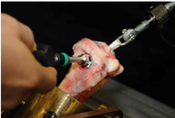
Abbildung 15: Eindrehen des Endotack® Fixationsbuttons mittels Buttonschlüssel und definiertem Drehmoment
