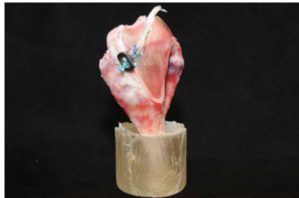
Abbildung 16: Anschnitt der porkinen Tibia mit Transplantat sowie Interferenzschraube und Endotack® Fixationsbutton
