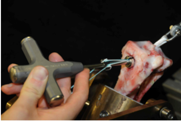
Abbildung 13: Ansetzen des Setzgerätes
