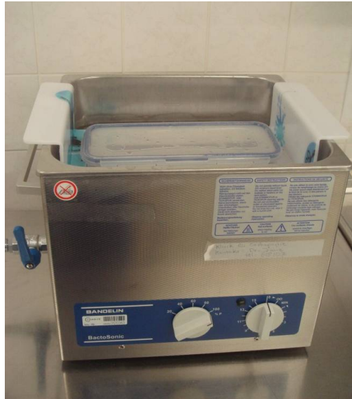
Abb. 3 Darstellung der Sonikation von Explantaten mittels Ultraschallbad
