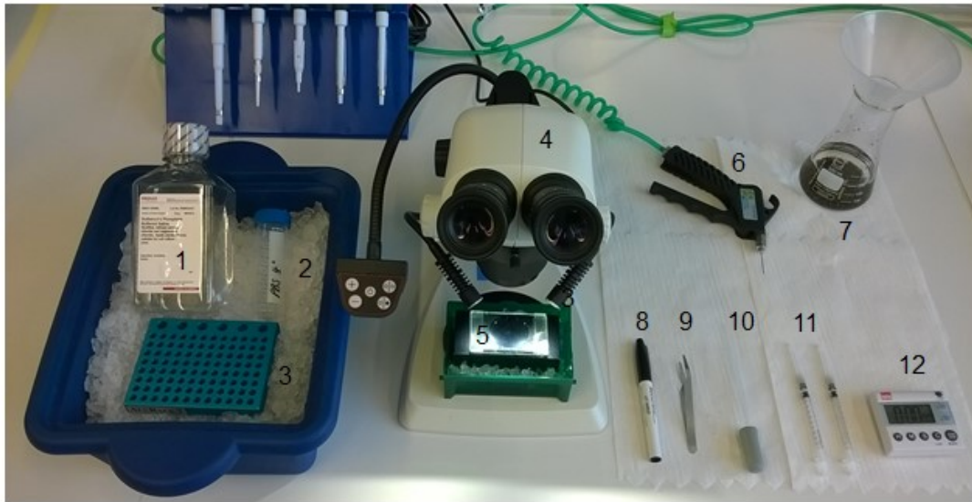
Abbildung 10: Utensilien für die Präparation der Nephrozyten aus L3. (1) PBS (2) Falcon mit eiskaltem PBS (3) Alu-Rack auf Eis für PCR-Gefäße (4) Binokularmikroskop (5) Mit PBS gefülltes Mikroskopierglas, Lagerung auf Eis (6) CO 2 -Pistole zur Betäubung der Fliegen und Larven (7) Becherglas mit Trichter (8) wasserabweisender Stift zur Kennzeichnung der PCR-Gefäße (9) stumpfe Pinzette (10) Pasteurpipette zum Transfer der präparierten Zellpakete (11) 1 ml Spritzen mit aufgesetzten Kanülen (16 G) als Präparierwerkzeug (12) Stoppuhr zur Kontrolle der Präparierzeit Eigene Aufnahme.
