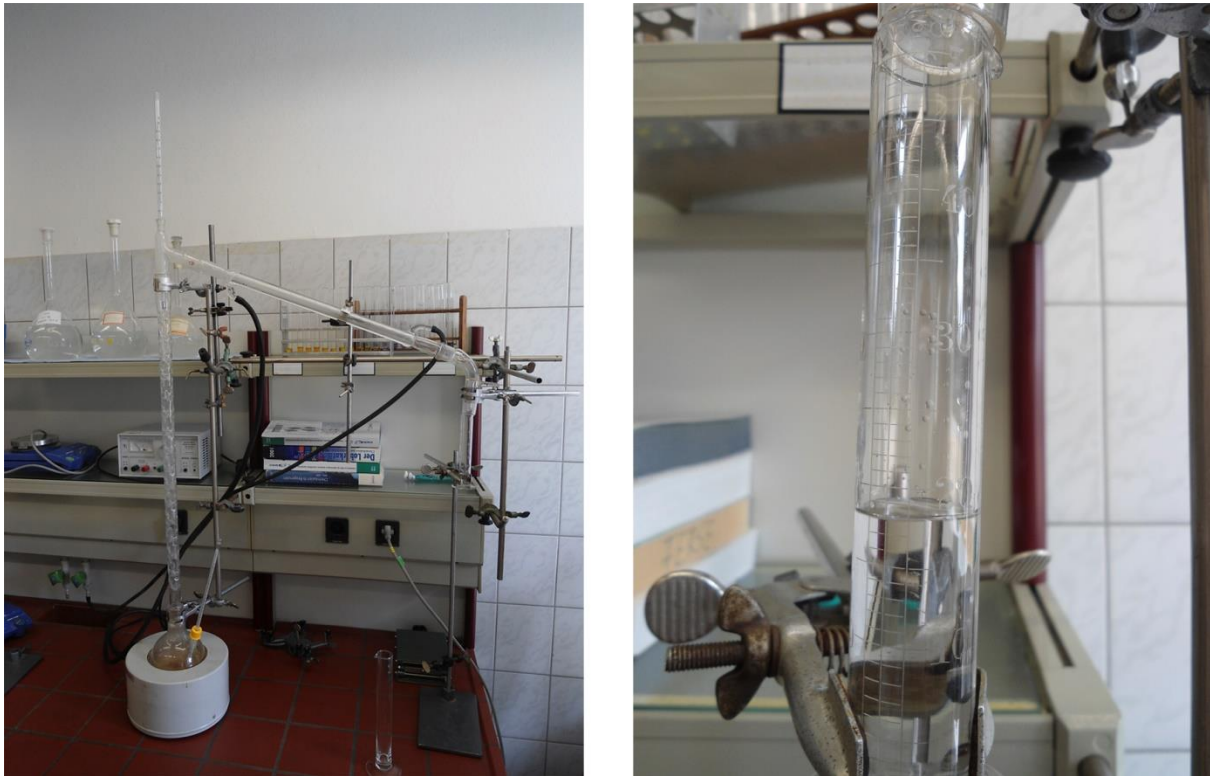
Abb. 76: (links) Versuchsaufbau und (rechts) aus der Probe gewonnener, reiner Alkohol.
