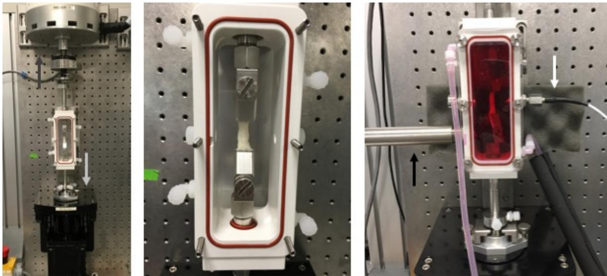
**Abbildung 30: Entwicklung eines Bioreaktormodells.** Die Sehne ist in der ‚Biodynamic Chamber‘ eingespannt und kann sowohl Zug- als auch Rotationskräften ausgesetzt werden. Dunkelgrauer Pfeil = Zugkraft; hellgrauer Pfeil = Rotation; schwarzer Pfeil: Sauerstoffsonde zur Messung der Sauerstoffkonzentration; weißer Pfeil = Temperatursonde zur Messung der Temperatur
