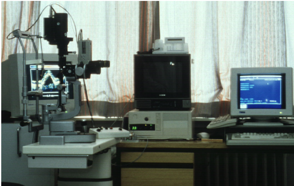
Abbildung 9. Prototyp zur Optischen Kohärenz-Tomographie (OCT) der vorderen Augenabschnitte unter Ankopplung an eine Spaltlampe.
