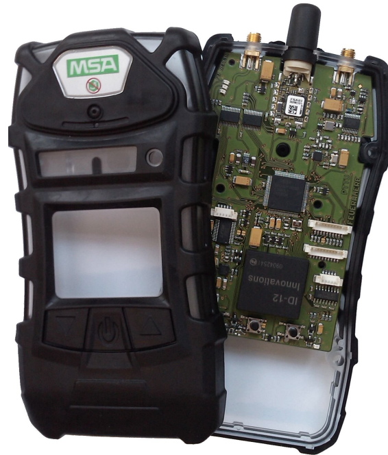
Abbildung 3.4: Eine PTTU mit Gehäuse und angeschlossener GPS-Antenne.
