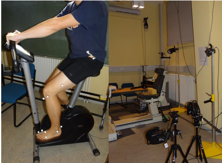
Abbildung 12 Ergometer und Dynamometer-Stuhl mit Motion-Capture-Kameras (91)
