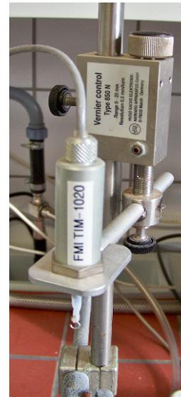
**Abb. 8: Kontraktionskraftaufnehmer und Feinpositionierelement**
