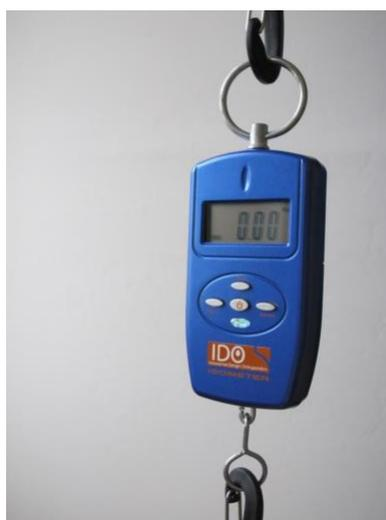
Abb. 15 IDO - Isometer zur Messung der Kraft, Fa. Innovative Design Orthopaedics, Reading, Großbritannien.
