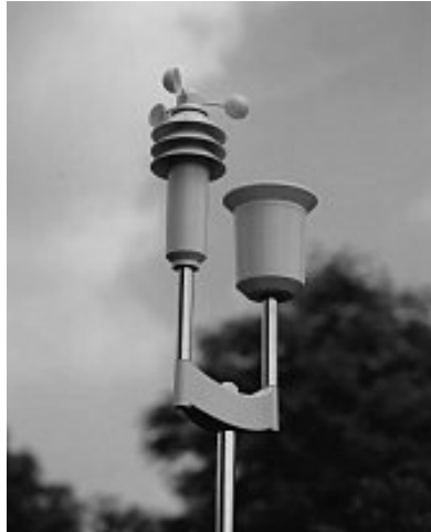
Abbildung 19: Kombisensor 555 der Wetterstation 444 PC, verwendet in der Zeit des entomologischen Monitorings auf den Milchviehanlagen in Lögow und Eichstädt, Brandenburg, 2008.
