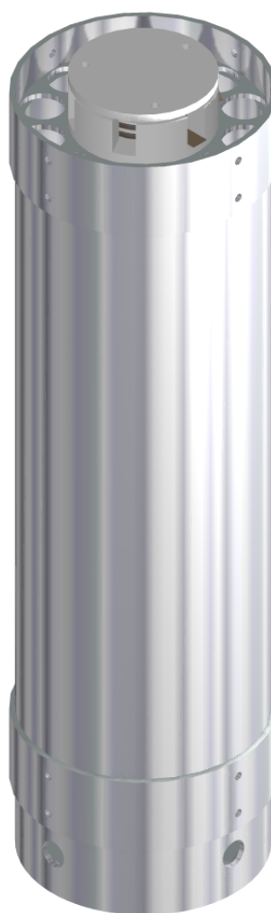
Abb. 3.28: Aufbau als MCP-Elektronendetektor mit Flugrohr. Von oben nach unten: MCP-Detektorkopf, abschirmendes Flugrohr, elektrostatische Linse.
