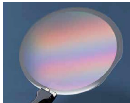
Abb. 27: FBH/TU – AlN-Template auf Saphir-Substrat mit einem Durchmesser von 2 Zoll (Foto von Website FBH (2013))
