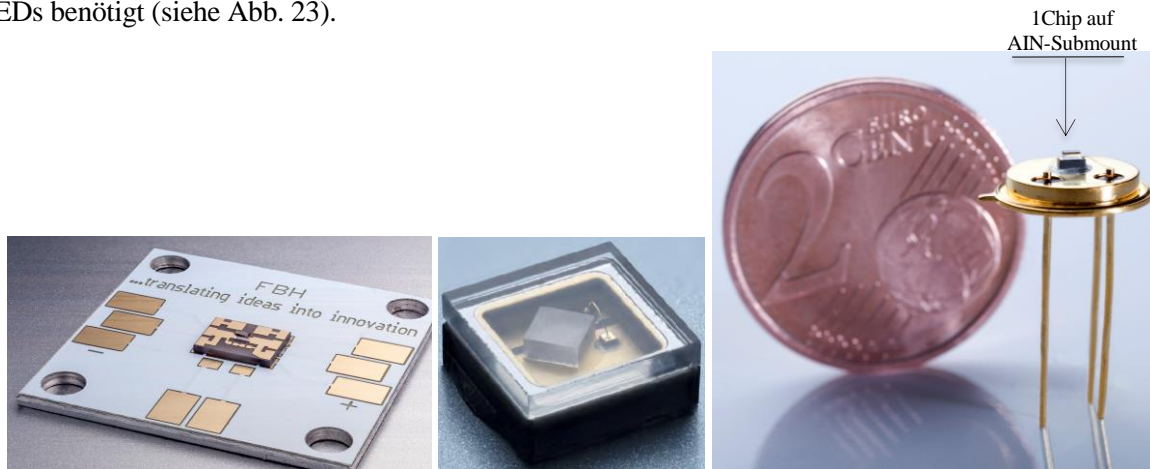
Abb. 23: FBH – UVB-LED auf SMD-Package, auf Keramik-Package und auf TO-Halter (Foto links von Website FBH (2018o), Foto mittig von Website FBH (2018n) und Foto rechts von Website (FBH, 2018g))
