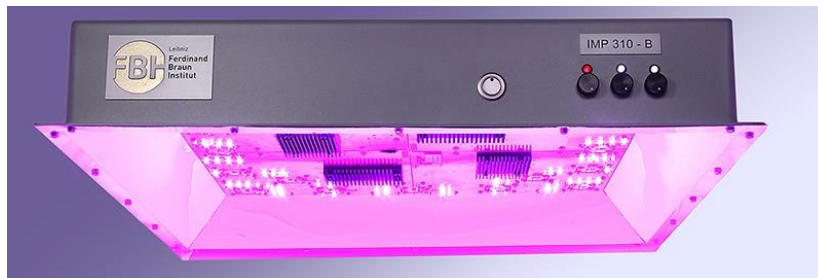
Abb. 29: FBH – UVB-LED-Modul zur Pflanzenbestrahlung mit Licht verschiedener Wellenlängen durch LEDs: UV (310 nm), blau (451 nm), rot (660 nm) (Foto von Website FBH (2018f))
