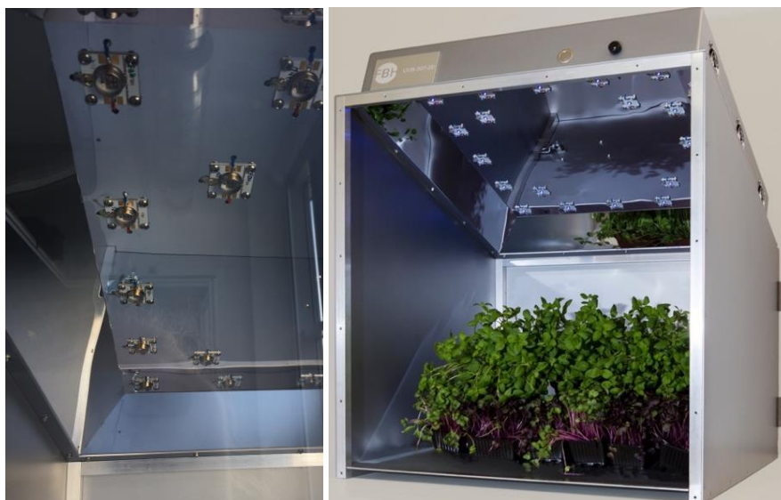
Abb. 33: FBH – Ausstellungsstück, UV-LED-Modul mit UV-LEDs auf SMD-Package (links: eigenes Foto, rechts: Foto von Website FBH (2018o))
