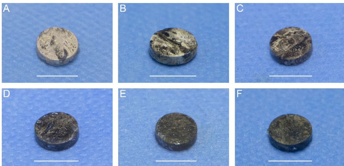
Abb. 41: Korrosion von reinem Magnesium in vivo A–F: reine Magnesiumimplantate an Tag 1, 3, 7, 14, 21 und 28 unmittelbar nach Entnahme, die Länge des Maßstabalkens entspricht jeweils 8 mm
