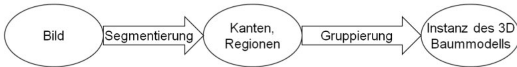
Abb. 2.23: Datengetriebener Ansatz der Einzelbaumextraktion (verändert nach Straub 2003a: 28)
