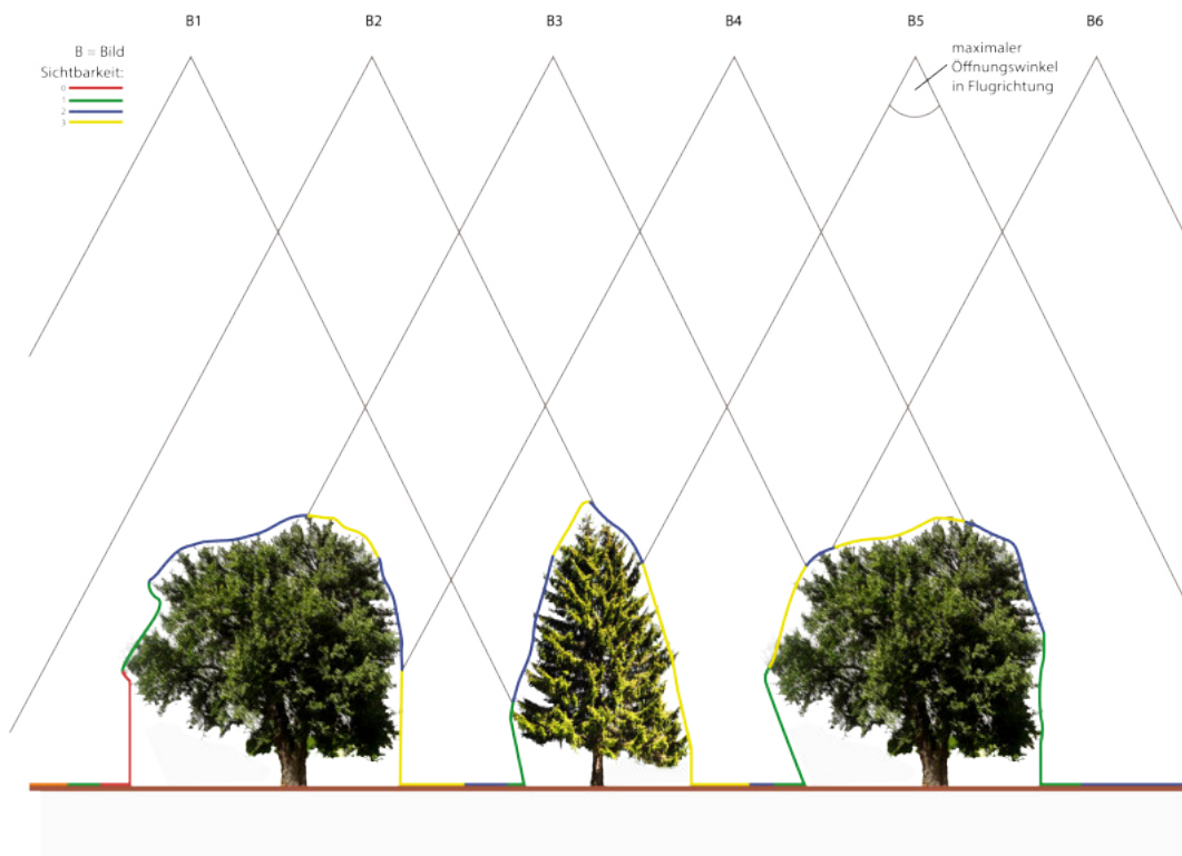
Abb. 4.2: Einfluss des Einschneidewinkels ( \alpha ) auf die Sichtbeziehungen von Bäumen
