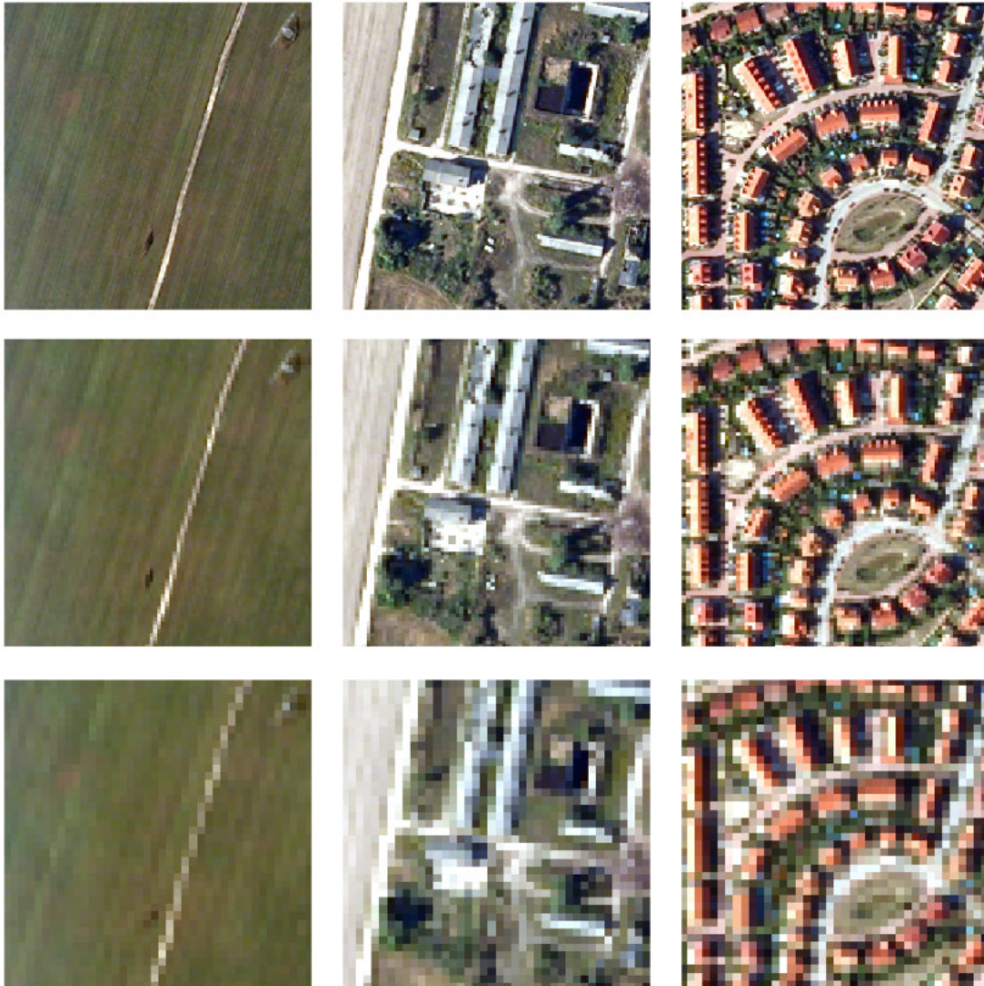
Abb. 2.16: Komplexität von Luftbildern (Auflösungen: obere Abbildung 50 cm, mittlere Abbildung 2,5 m, untere Abbildung 5 m) (verändert nach Hinz 2004: 14)
