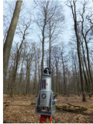
Abb. 3.6: Terrestrische Messung der Kontrollbäume mit dem Riegl Laser Scanner LMS Z620
