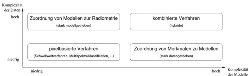
Abb. 2.21: Einteilung der Ansätze der Bildauswertung hinsichtlich Komplexität der Daten und Modelle (Hinz 2004: 19 verändert nach Suetens et al. 1992: 13)
