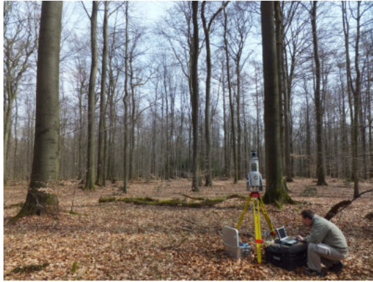
Abb. 3.6: Terrestrische Messung der Kontrollbäume mit dem Riegl Laser Scanner LMS Z620
