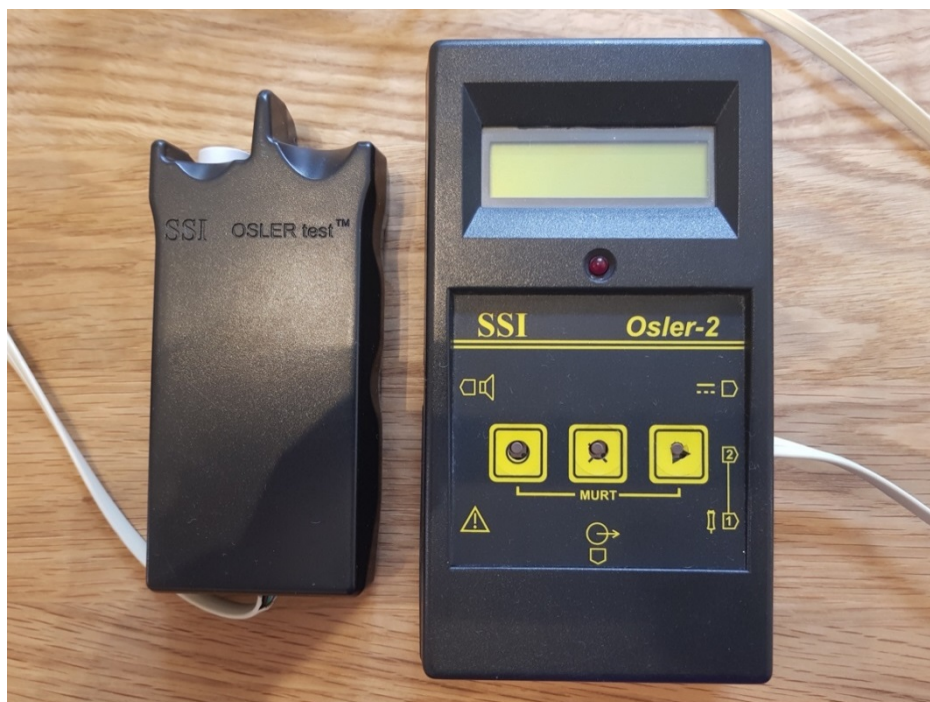
Abbildung 1: Osler-2 Device – links der Proximity Switch mit dem berührungsempfindlichen grauen Knopf – rechts die Display Unit mit der roten LED, dem Display zur Darstellung der Ergebnisse und den Steuerungstasten
