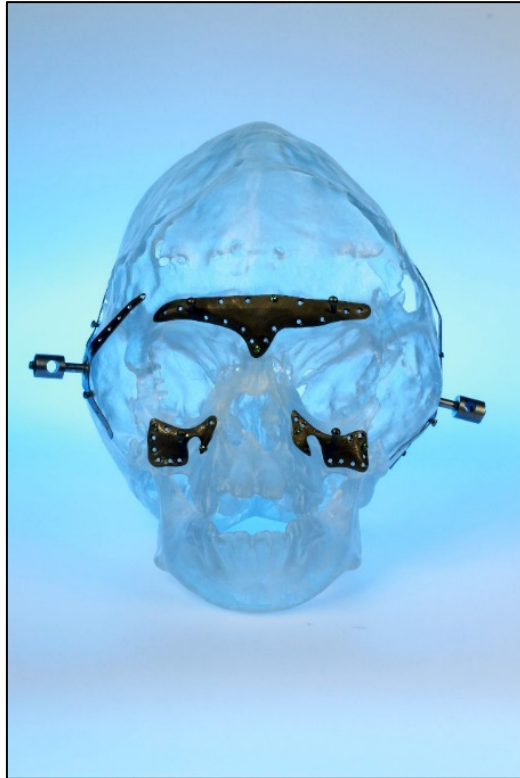
Abbildung 11: Die durch Selektives-Lasermelting-(SLM-)Verfahren (KLS Martin) patientenspezifisch gefertigten Verankerungskomponenten für einen rigiden externen Distraktor (RED Device) zur Verlagerung des frontofazialen Komplexes
