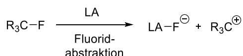
Schema 1.14: Schematische Darstellung der heterolytischen C-F-Bindungsspaltung unter Verwendung einer fluorophilen Lewis-Säure (LA).
