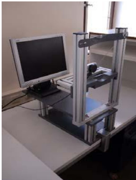
Abb. 6: Versuchsaufbau bei der Zungenkraftmessung.
