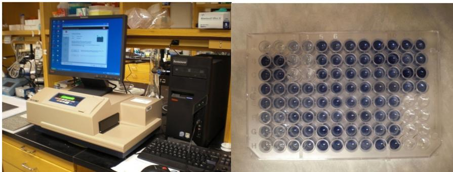
**Abb. 18:** Versuchsaufbau Proteinquantifizierung nach Bradford.
