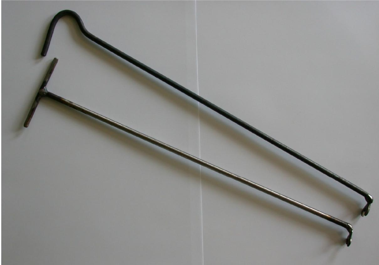
Abb. 51, 8-mm-PH-Schraubschlüssel (T-Griff und gebogener Griff)
