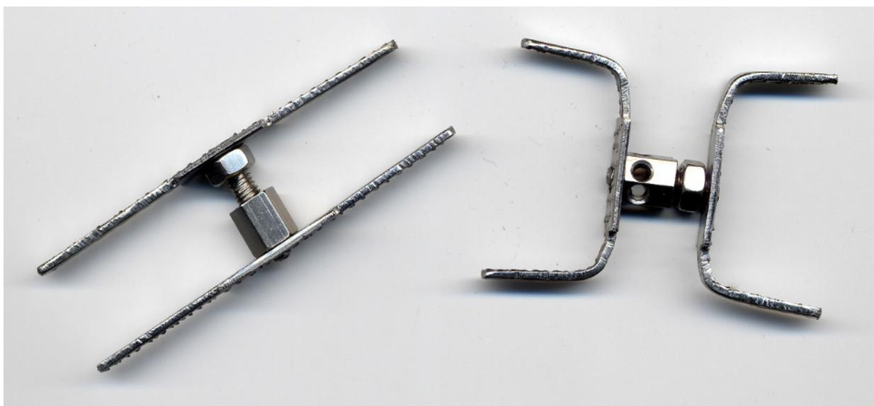
Abb. 80, PH 8 (Modell 9 c; PH-Nr. 3, 4, 5). Links sind die Zahnstücke noch ungebogen, rechts trägt der Hohlzylinder Querbohrungen für einen Stiftansatz.
