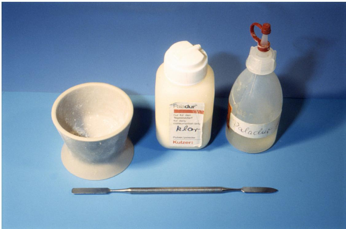
Abb. 28, Paladur®-Pulver, Kondensator-Flüssigkeit, Spachtel und Anmischgefäß aus Gummi.
