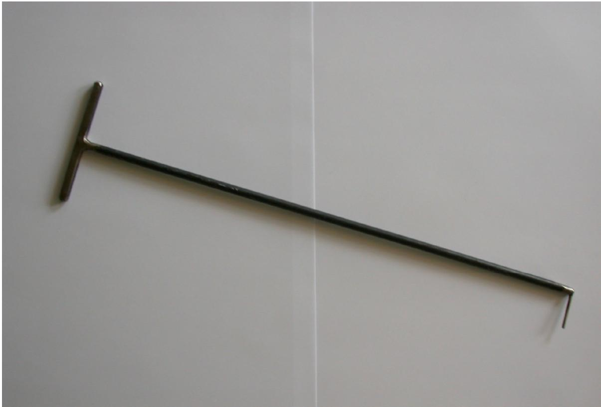
Abb. 53, 3-mm-PH-Schraubstift
