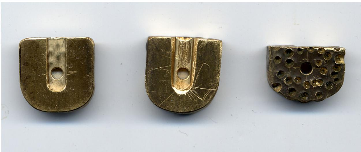
Abb. 88, Lochplatten, links unbearbeitet, mitte mit abgeflachter Rinne,
