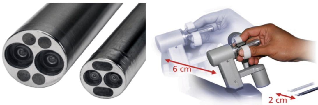
**Abb. 2:** getunneltes optisches Endoskop (links) und Joystick für die Hände (rechts), [www.intuitivesurgical.com/company/media/images/](http://www.intuitivesurgical.com/company/media/images/) (15)
