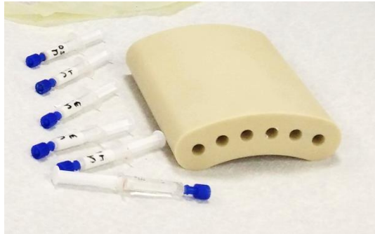
Abbildung 5: Epoxidharz-Phantom mit 6 aufgezogenen Spritzen
