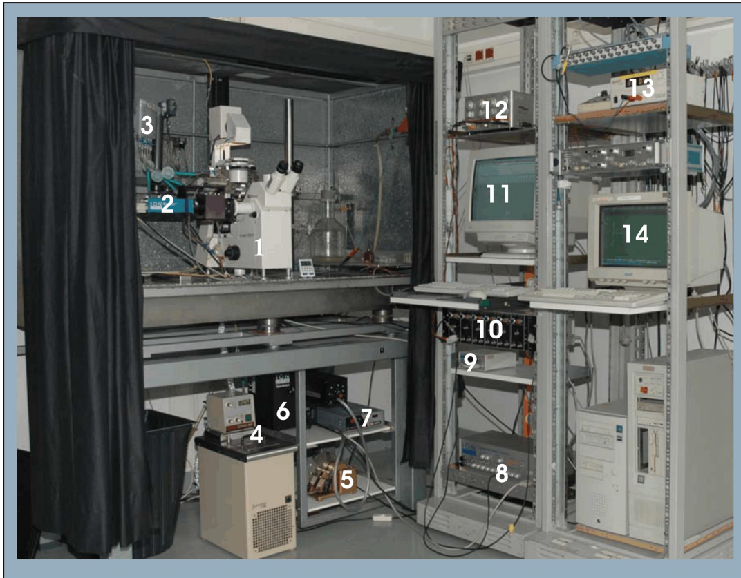
Abbildung 2.5.: Versuchszustand. 1 Mikroskop Axiovert 100 TV; 2 IonOptix MyoCam; 3 Perfusionsystem; 4 Julabo F10 Wärmebad; 5 HyoFlo Absaugpumpe; 6 IonOptix HyperSwitch; 7 Transformator für die Xenonlampe; 8 IonOptix Fluorescence System Interface; 9 IonOptix Kamerasteuerungselement; 10 Verstärker; 11 Kontrollmonitor für die Datenerfassung; 12 Grass SD 9 Reizgerät; 13 Transformator für die Hellfeldlampe; 14 Kontrollmonitor für Steuerung des Reizmusters
