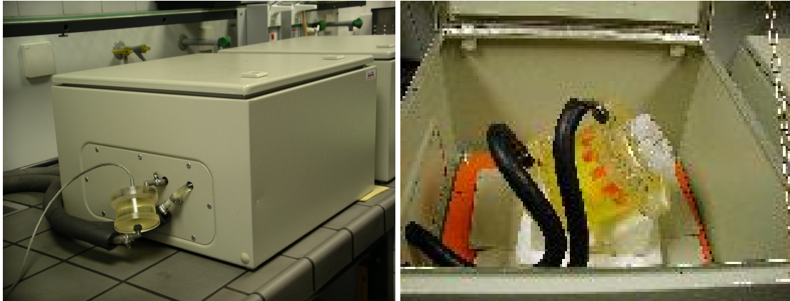
Abb. 5: Hochfrequenz-Abschirmbox (HF-Box bzw. Kontrollbox) in der Gesamtansicht (links). Detailaufnahmen der Acrylprobenhalter mit den Versuchsröhrchen in der Hochfrequenz-Abschirmbox (rechts). Die Hochfrequenz-Abschirmbox wurde vom Forschungsverbund „EMV Biologischer Systeme“, TU Braunschweig, zur Verfügung gestellt.
