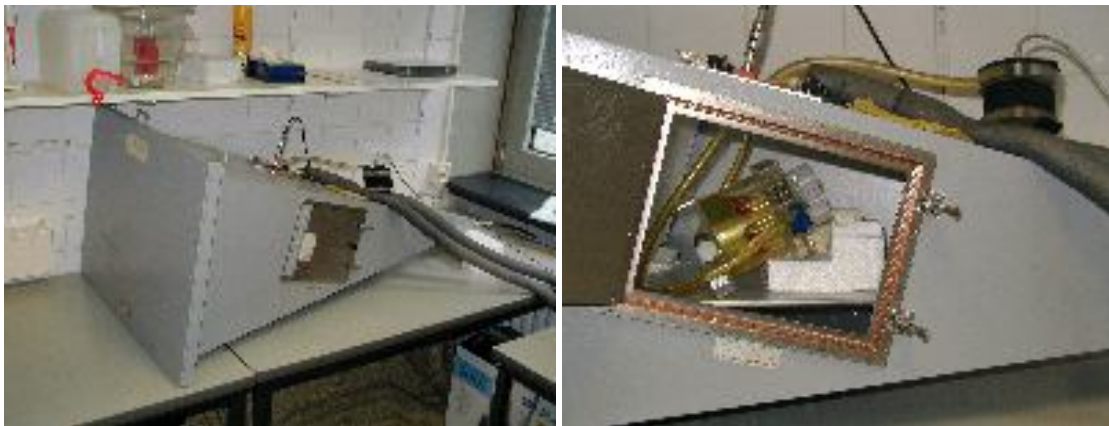
Abb. 4: GTEM-Zelle (Hersteller EMCO, USA, Modell 5302) als Feldgenerator in der Gesamtansicht (links). Detailaufnahme der Acrylprobenhalter mit den Versuchsröhrchen in der GTEM-Zelle (rechts). Die GTEM-Zelle wurde vom Forschungsverbund „EMV Biologischer Systeme“, TU Braunschweig, zur Verfügung gestellt.
