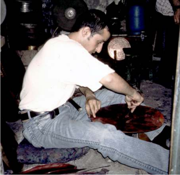
Abb. 2 Nutzung eines Zirkels am Anfang des Punzierungsvorgangs.
