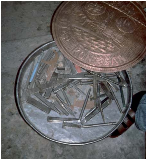
Abb. 10 Schale mit simplen Punzen, die bei der Verzierung verwandt wurden.
