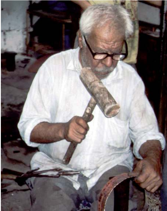
Abb. 13 Arbeit mit dem Klopfholz an einem Kupfergefäß (in Nachbarschaft zur hier beschriebenen Ladenwerkstatt).
