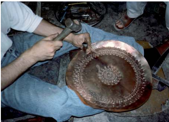
Abb. 7 Ornamentierung der klammerförmigen Motive mittels einer kleinen sternförmigen Punze als dreifach genutztes Füllelement.
