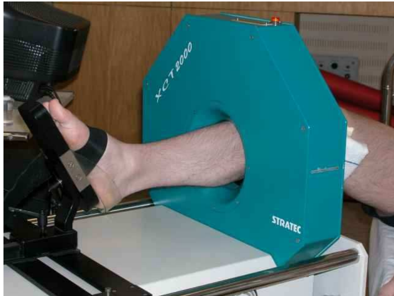
Abbildung 2.6-I: XCT 2000 Bone Scanner der Firma Stratec Medizintechnik / Pforzheim, der in der Studie verwendet wurde.
