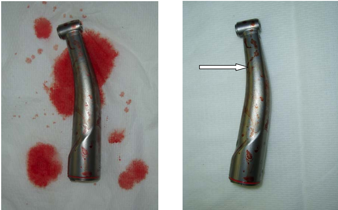
Abbildung 3-1: Im Praxisversuch mit Blut beschmutztes Winkelstück Sirona T1 vor der Aufbereitung (links) und nach der Aufbereitung (rechts) im Turbocid. Pfeil: deutlich erkennbare Blutreste
