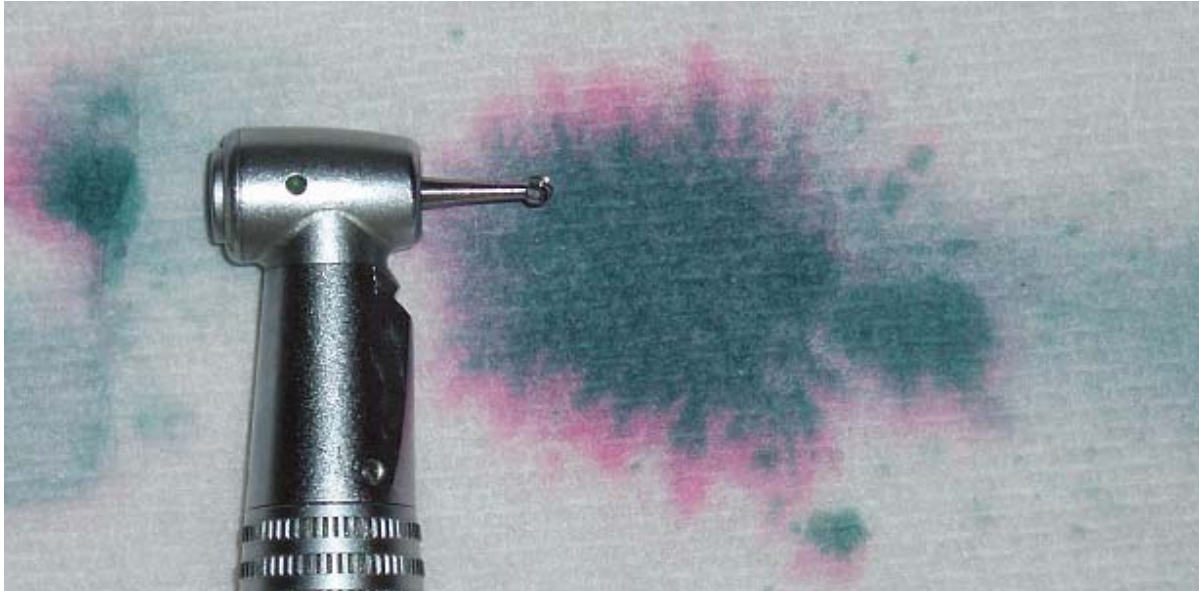
Abbildung 1-3: Rücksaugeffekt bei Behandlungsstuhl KaVo Esthetica 1042
