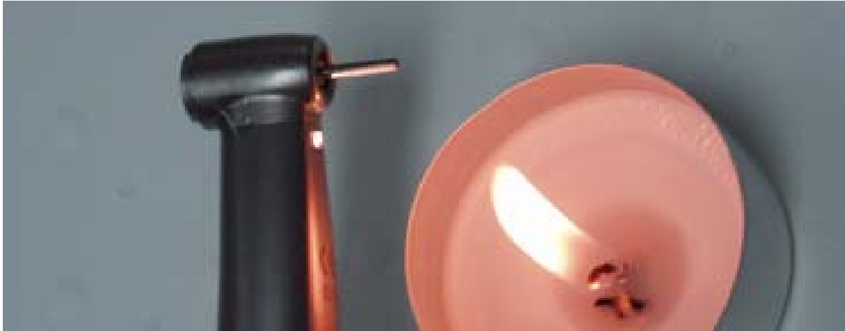
Abbildung 1-4: Bewegung einer Kerzenflamme durch Unterdruck zur Unterseite des eingespannten Schleifkörpers
