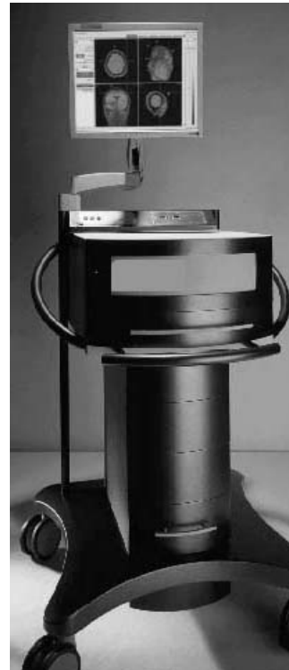
Abb.3.2: Basisstation des gleichstromgepulsten elektromagnetischen Neuronavigationssystems.
