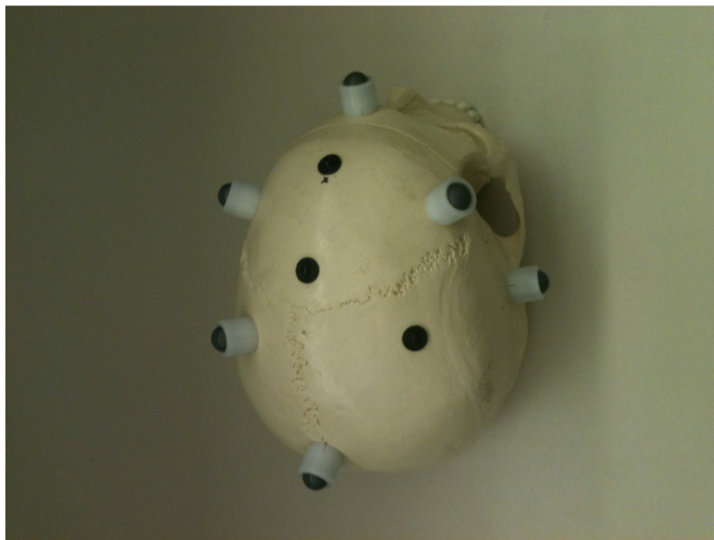
Abbildung 3.8: Anordnung der Fiducials am Patientenkopf zur optimalen Registrierung.
