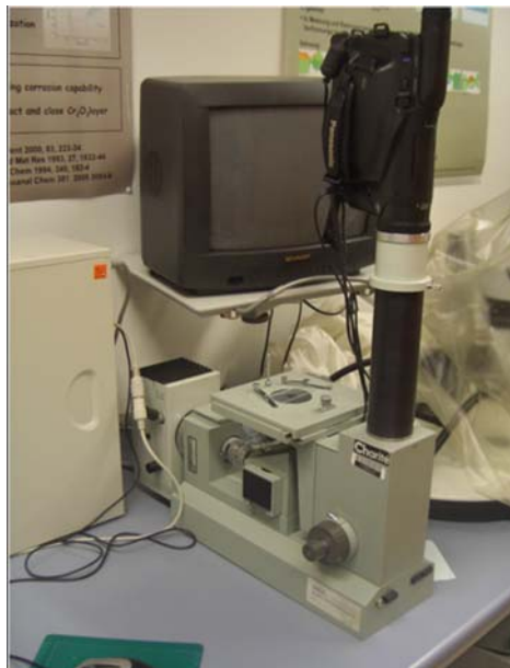
Abbildung 5-17: Auflichtmikroskop Metaval [CZ Jena] mit aufgesetzter Video-Kamera [Panasonic]
