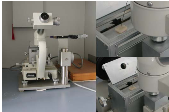
Abbildung 5-11: Randwinkelmessgerät der Firma Copy Kryss, links: Übersicht, rechts: Details
