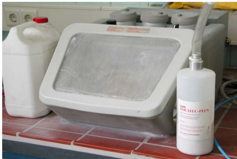
Abbildung 5-13: Bego Strahlgerät Topstar [Bego Bremen,D]
