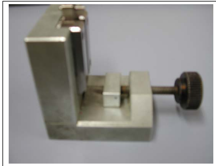
Abbildung 5-16: Druck - Scherversuch, oben links : Prüfkörper vor Versuch, oben mitte : Prüfkörper nach Versuch, oben rechts : Prüfkörper nach Versuch, unten : Einspannvorrichtung
