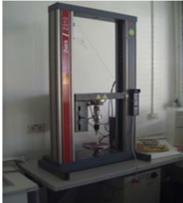
Abbildung 5-14: Universalprüfmaschine Zwick Z 010 zur Bestimmung der Verbundfestigkeit
