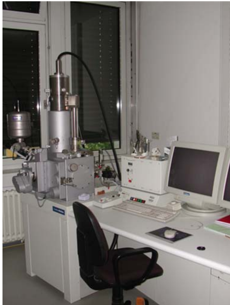
Abbildung 5-18: Rasterelektronenmikroskop MaXim 2040S [CamScan Electron Optics Ltd., Cambridge, UK]
