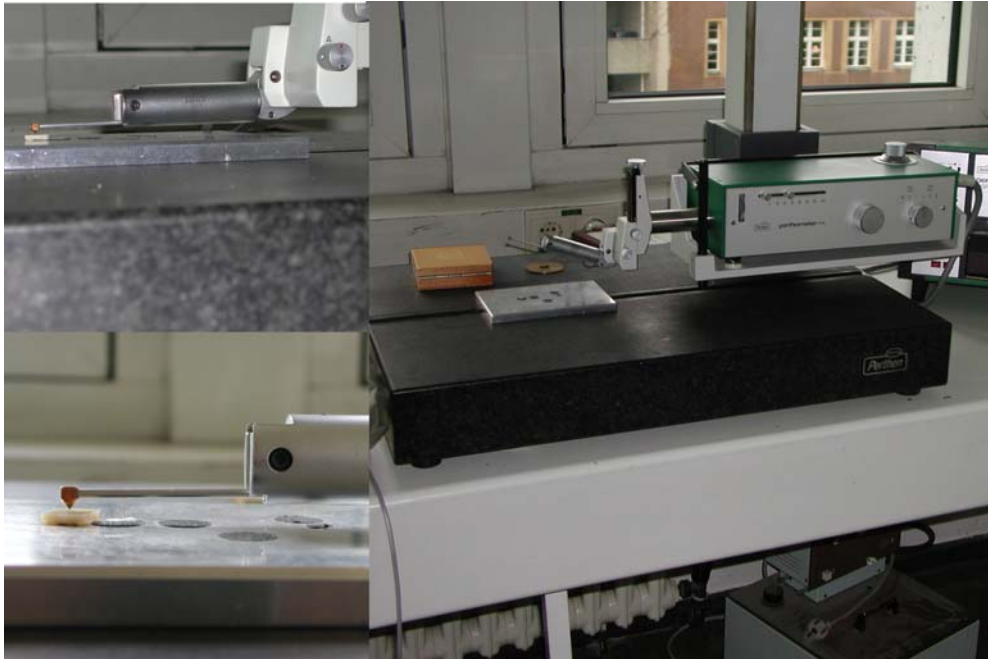
Abbildung 5-9: Rauheitsmessung, rechts : Übersicht und links : Details, Probe mit aufgelegter Tastspitze
