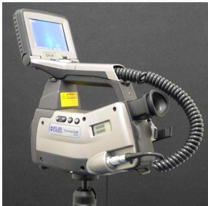
Abbildung 28: FLIR ThermoCAM S60 für die Temperaturmessung auf der Hautoberfläche.
