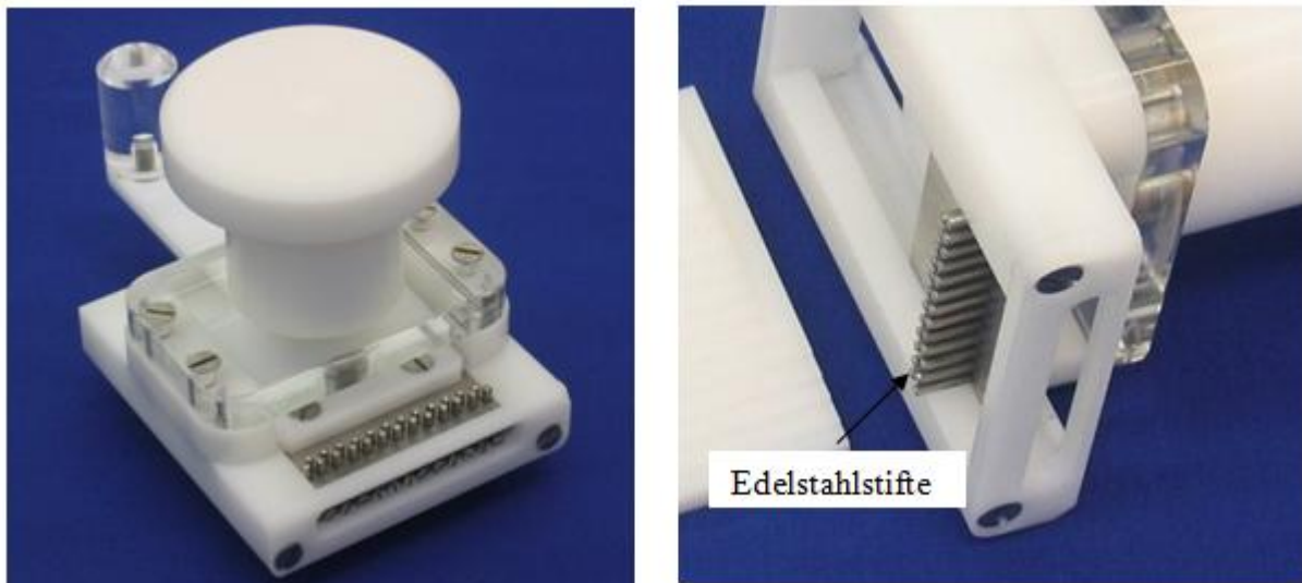
Abbildung 11: Darier Testgerät 1.0 mit Detailansicht der Edelstahlstifte
