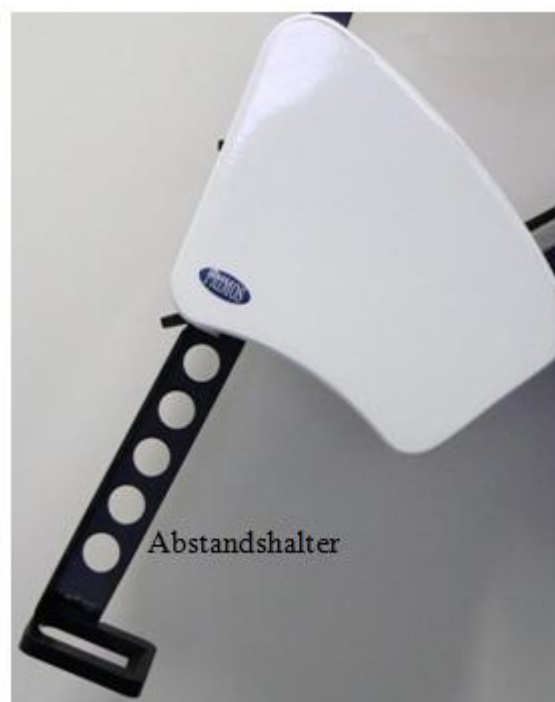
Abbildung 15: PRIMOS contact Messgerät mit Abstandshalter zur dreidimensionalen Darstellung der Hautoberfläche
