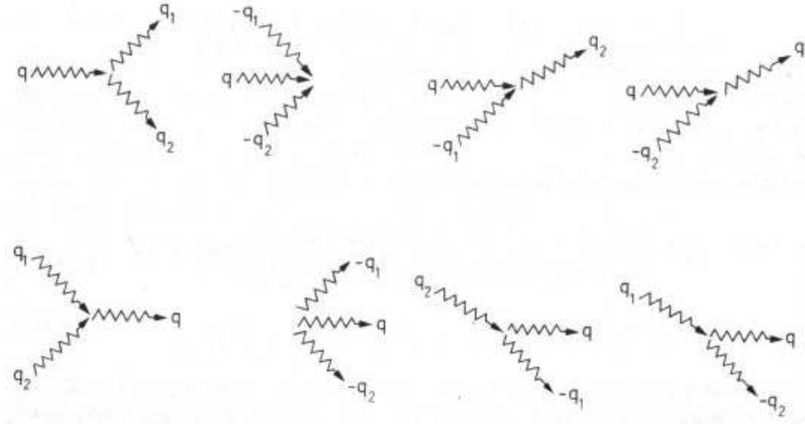
Abbildung 1.1: Darstellung für Drei-Phononen-Streuprozesse. Bei Prozessen der ersten Reihe wird ein Phonon \mathbf{q} vernichtet, bei den Prozessen der zweiten Reihe wird ein Phonon \mathbf{q} erzeugt. Die Abbildung ist aus [Mad72] entnommen.
