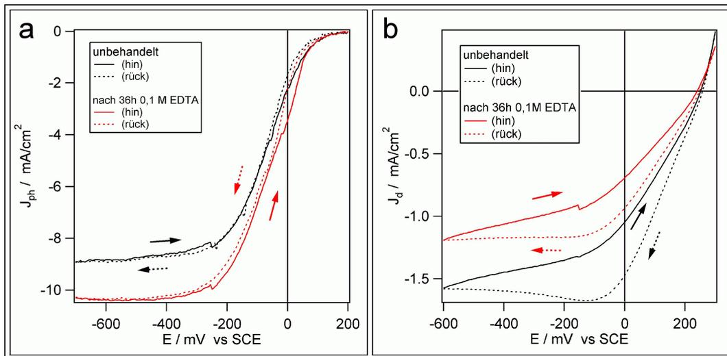
**Abb. 9.20:** Kennlinien einer für 36 h ganzflächig mit 0,5 M EDTA behandelten p-WSe<sub>2</sub>-Kristallprobe:
