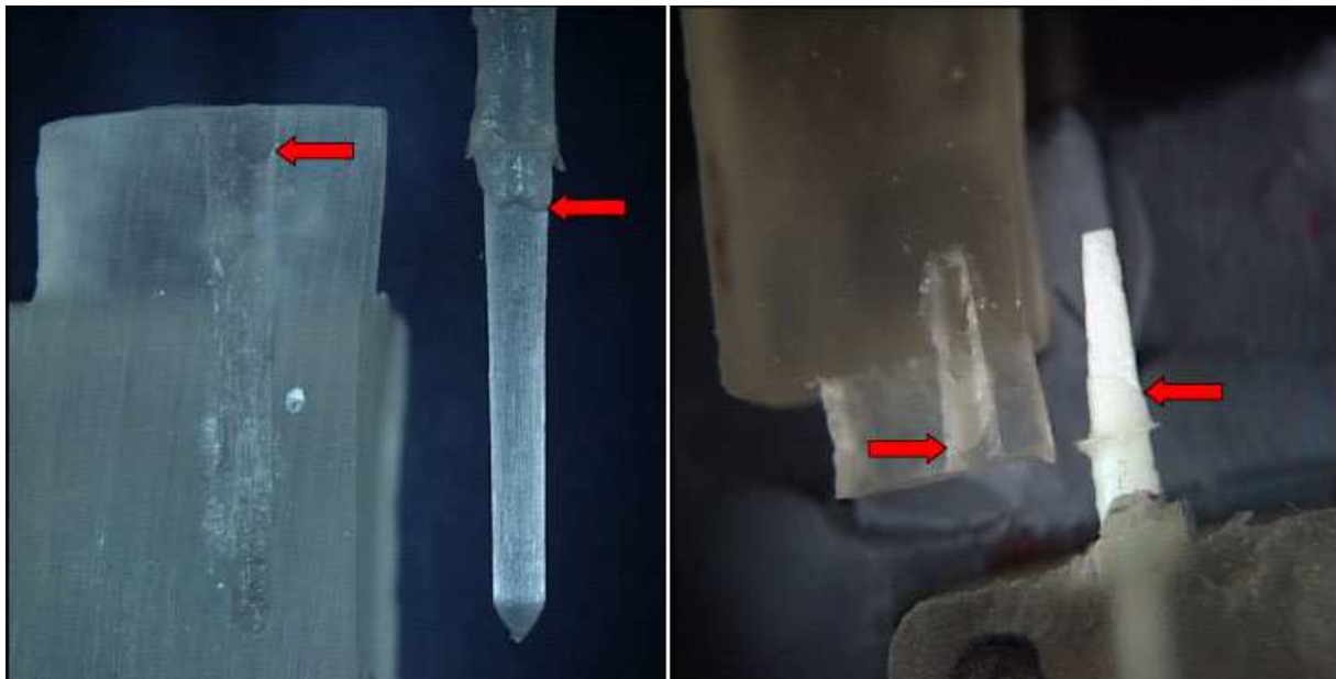
Abb. 1: Gegenüberstellung beider Stiftsysteme nach Abzugsversuch mit verbliebenem adhäsiven Befestigungszement (siehe rote Pfeile), links DT-Stift, rechts Cytac-Stifte.
