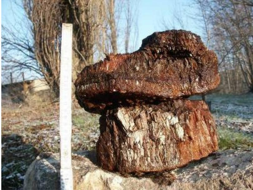
Abbildung 2: Zwei TNT- Brocken je 20 x 20 x 10 cm aus dem Umfeld einer gesprengten Kühlschikane eines Sprengstoffwerkes
