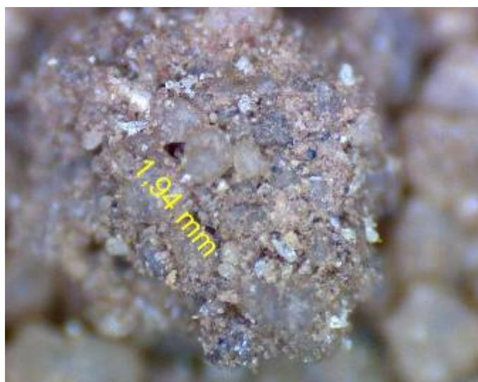
Abbildung 10: Mit Sand „verbackenes“ TNT, z. B. nach Schmelze oder Auskristallisation
