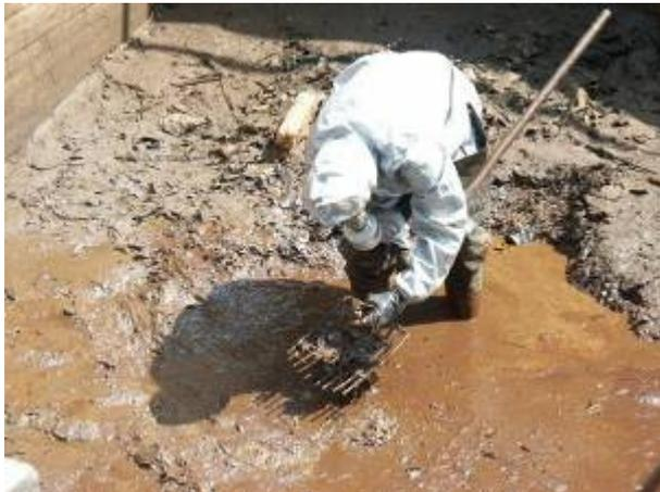
Abbildung 3: Probennahme von TNT- Brocken aus Abwasserschlämmen
