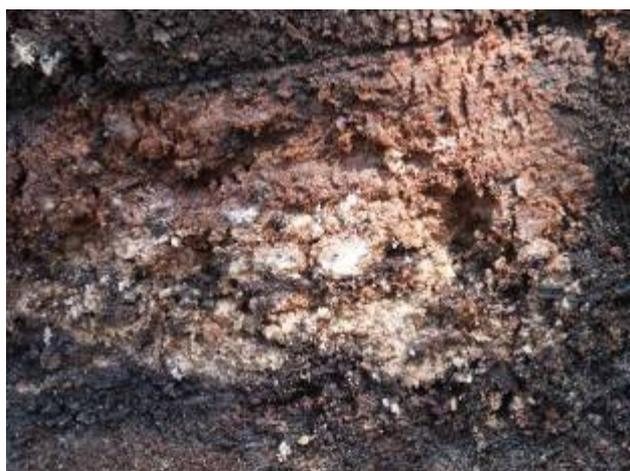
Abbildung 22: Mit TNT-Stücken und auskristallisiertem TNT hoch belasteter Oberboden, vergrößert aus dem nebenstehenden Schurf
