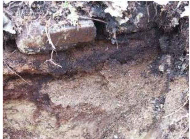
Abbildung 4: Auskristallisiertes TNT unter einer Produktionsanlage
