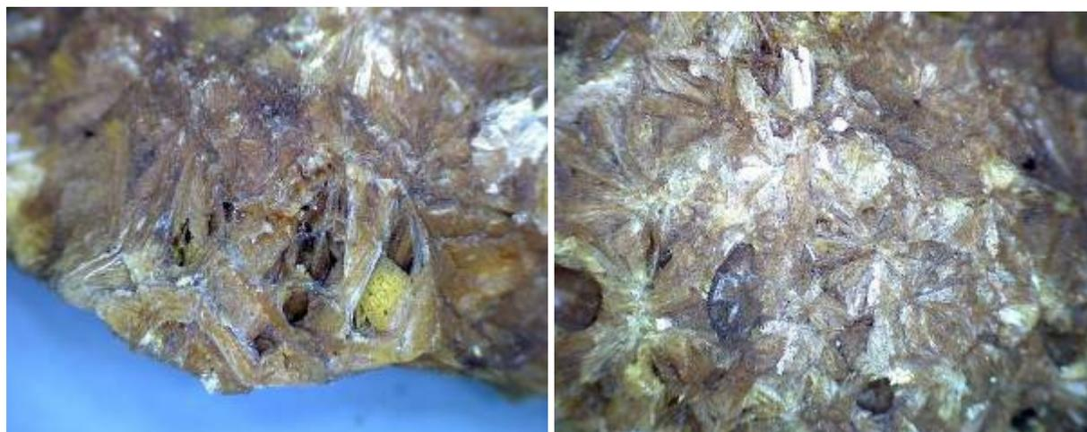
Abbildung 16: TNT auskristallisiert (mikroskopisch von Bodenfund im Sprengstoffwerk)
