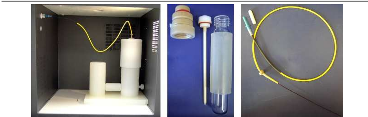
Abb. 18: MonoPREP in der Synthesemikrowelle, Quarzreaktorsystem mit Thermorohr, Faseroptiksensoren (von links nach rechts)
